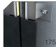
FTS 503_B / FTS 503_B' FIBROCEMENTO / FIJACIÓN ELÁSTICA
